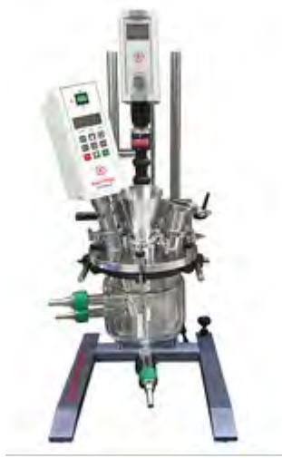
Лабораторные системы REACTRON® состоят из ёмкости для проведения процесса (с рубашкой или без неё, стандартной или специальной геометрии), мешалки для макро-перемешивания (например, якорной) , системы POLYTRON® / MEGATRON® для гомогенизации, измельчения и микро-перемешивания, трубопроводов, системы контроля процесса и аксессуаров в соответствии с требованиями заказчика, характеристиками продукта и процесса.
