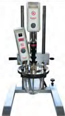
Лабораторные системы REACTRON® состоят из ёмкости для проведения процесса (с рубашкой или без неё, стандартной или специальной геометрии), мешалки для макро-перемешивания (например, якорной), системы POLYTRON® / MEGATRON® для гомогенизации, измельчения и микро-перемешивания, трубопроводов, системы контроля процесса и аксессуаров в соответствии с требованиями заказчика, характеристиками продукта и процесса.
